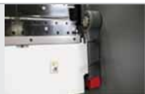
Reglare traversa indoire conform cu grosimea materialului
