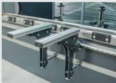
Brate suport fata cu reglare pe inaltime
