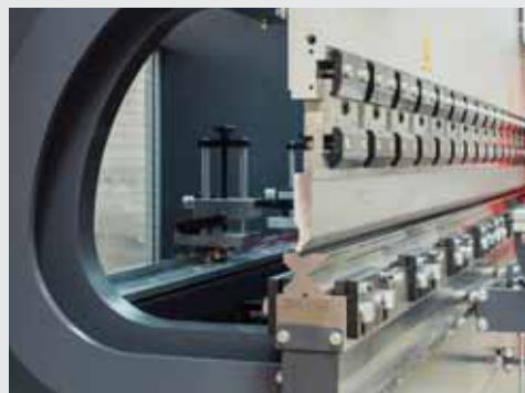
Sistem protectie laser DSP-AP + Modul PLC de siguranta MCS (manual)
