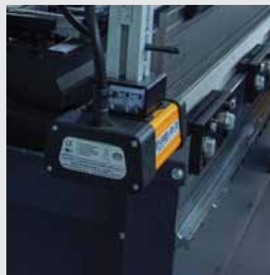
Sistem protectie laser DSP-AP + Modul PLC de siguranta MCS (manual)
