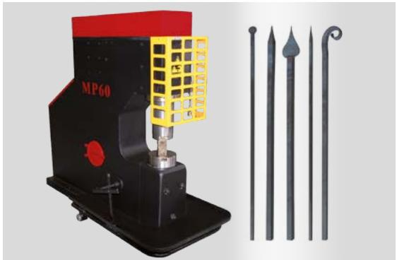
Los martillos pilones o martinetes MP Nargesa se utilizan en muchas herrerías para fabricar todo tipo de piezas para la forja ornamental facilitando el trabajo de moldear el hierro en caliente.
