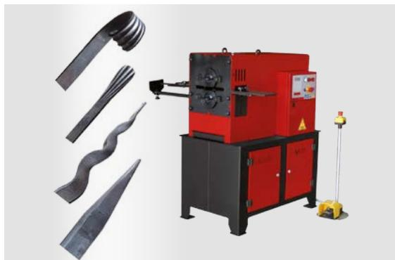
La maquina de forja en caliente Nargesa NF70, realiza las puntas de flecha, puntas lisas, puntas estriadas etc. en redondo, cuadrado o pletina de diferentes medidas... [+info](#)
