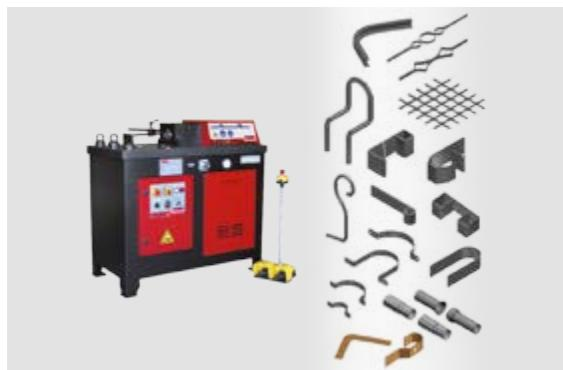
La versatilidad de la Prensa Plegadora Horizontal NARGESA PP200 de 20 toneladas nos permite doblar, plegar, curvar, cortar, conformar en frío, ensanchar y reducir, abocardar, embutir, ensamblar... [+info](#)
